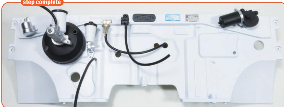
step 4 將艙壁隔板安裝到底盤上
