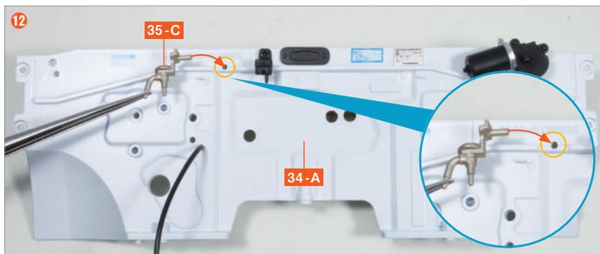
將加熱器水閥 35-C 的突起部分插入 34-A 的洞孔中。
