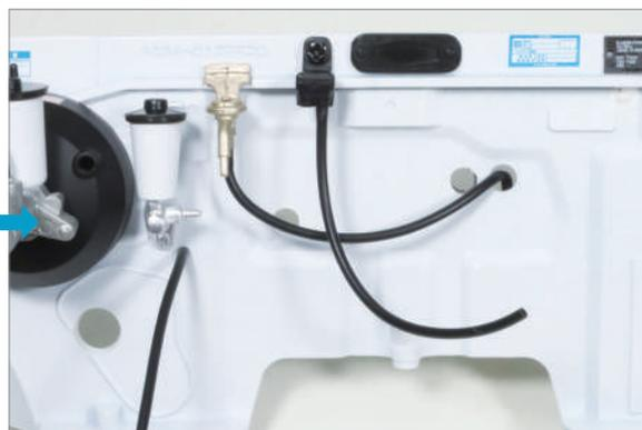
把在 **step1** 中裁剪出來的真空感測器水管 **35-O**，插入到 **35-A** 的突起部分上。
