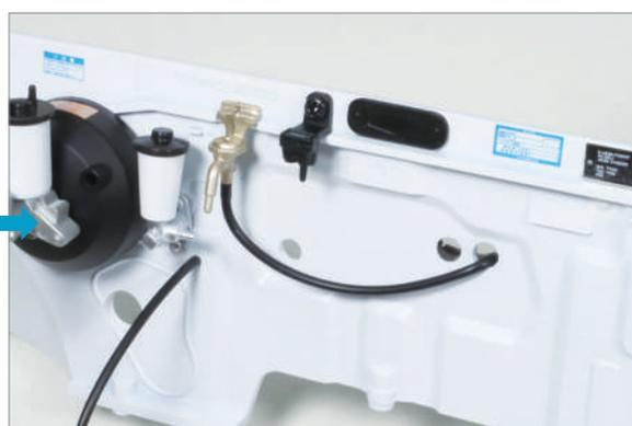
將 **step1** 中裁剪出來的加熱器進水管 E **35-N** 的一端插入 **35-C** 的後側突起部分。再將另一端插入 **34-A** 的洞孔中。
