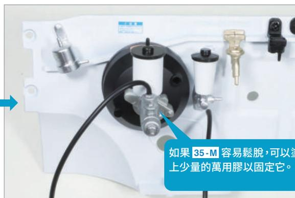
將從 **step1** 中裁剪出來的後輪煞車管 No.1 **35-M**，插入到 **35-I** 的洞孔中。
